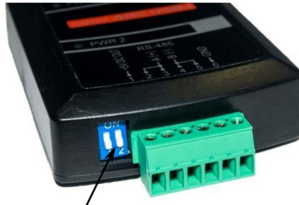
DIP-switch ON: terminacja RS485 podłączona
